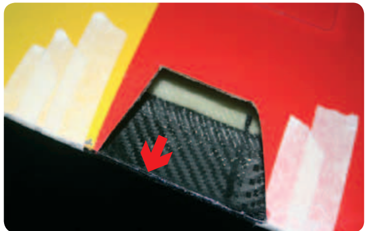
Hier wird die eine Seite exakt bis zur Nasenleiste laminiert und dann werden gleich noch ein paar CF-Rovings zur Verstärkung der Nasenleiste eingelegt.
