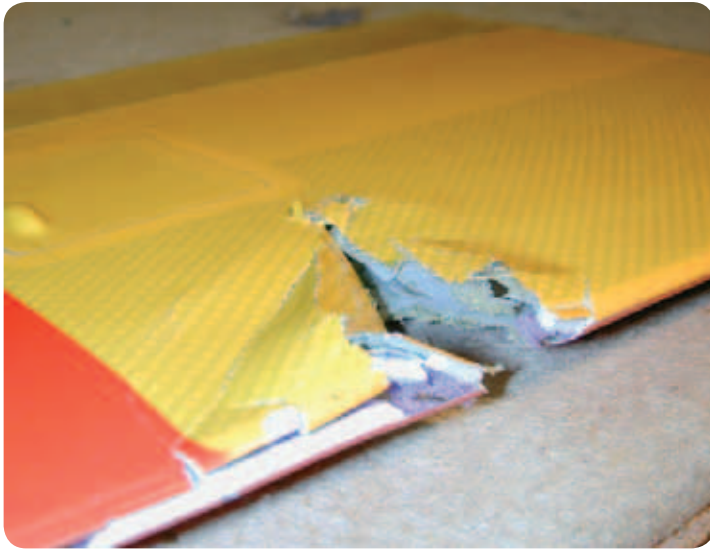
So sieht eine Pike-Superior-Tragsfläche an der Unterseite aus, wenn der Pilot einen Baum übersehen hat.
