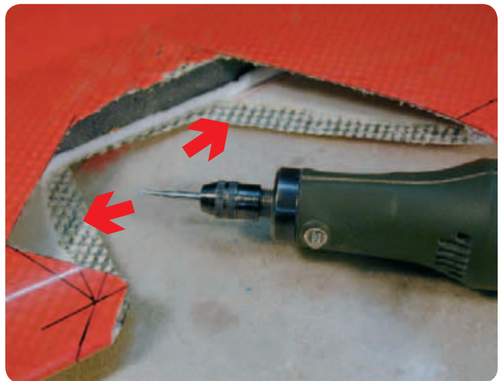
Im Randbereich wird innen der Stützstoff weggeschliffen damit das Reparaturlaminat eine Auflagefläche hat, wenn später gegen die Form laminiert wird.
