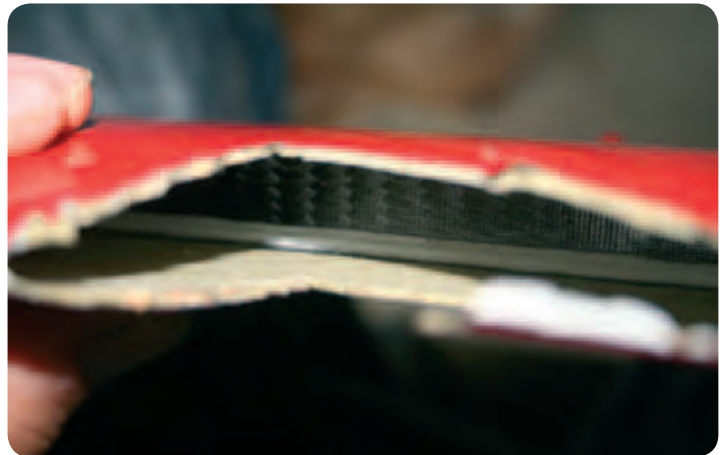
Auch hier muss der Holm gut kontrolliert werden. Allfällige Schäden am Holm können die ganze Reparatur innert Sekunden zunichte machen.
