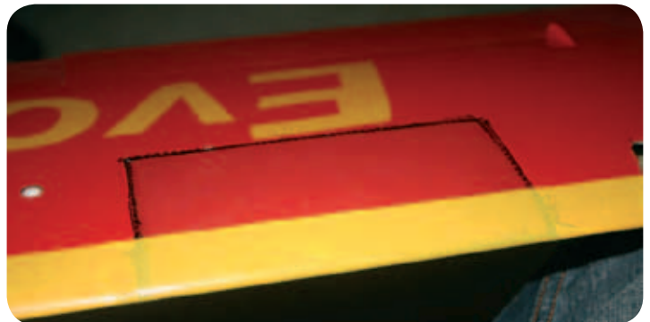
Hier geht es ebenfalls darum, die Oberseite und die Unterseite separat abzuformen. Dabei wird das Gewebe etwas um die Nasenleiste herum laminiert und mit einem Klebeband zum Aushärten fixiert.
