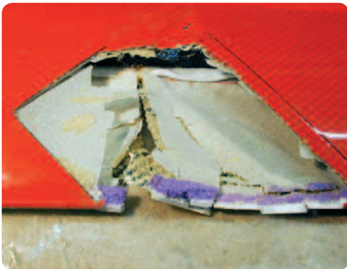
Zuerst wird alles zerstörte Material mit einer feinen Säge oder mit einem Messer weggeschnitten.
