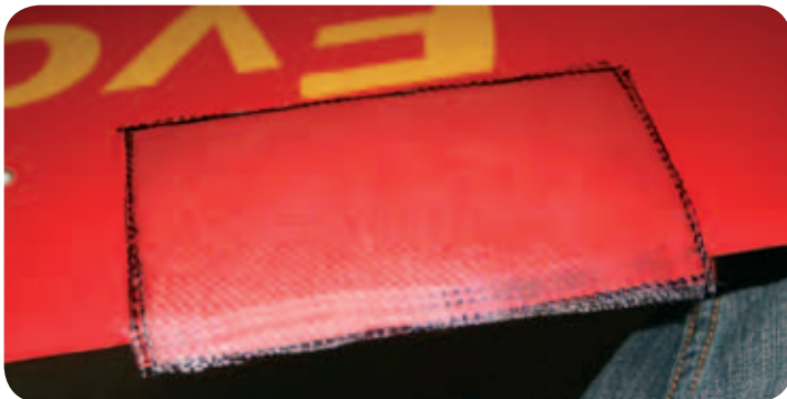
Hier geht es ebenfalls darum, die Oberseite und die Unterseite separat abzuformen. Dabei wird das Gewebe etwas um die Nasenleiste herum laminiert und mit einem Klebeband zum Aushärten fixiert.
