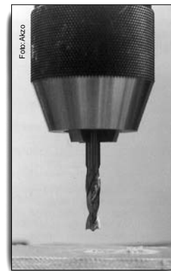
Bohren von Twaron® (Aramid)-Laminaten mit einem Hartmetallbohrer mit spezieller „Sichel-Schneide“
