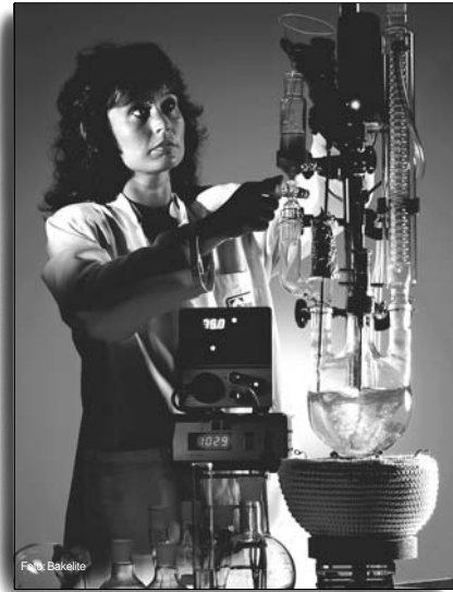
Epoxydharzherstellung im Labormaßstab Epoxy resin manufacture on a laboratory scale
