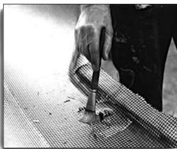
Handlaminat Tränken eines Kohle/Aramid-Gewebes mit Epoxydharz für einen Segelflugzeugrumpf.
