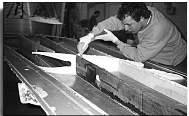
Aufbringen eines gefüllten Epoxydharzes zum Verkleben der Tragflächen-Halbschalen
