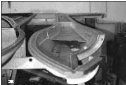
Im nächsten Arbeitsschritt werden die Einbauten in die Rumpfhältschalen eingeklebt.
