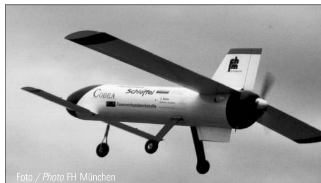
COBRA, ein unbemannter und ferngesteuerter fliegender Versuchsträger der Fachhochschule München
