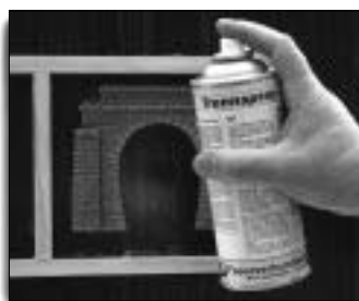
Vor dem Abformen wird Trennspray aufgetragen und dann der PU-Kautschuk vergossen
