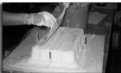
Herstellung einer Negativform für einen Behälter Making of a female mould for a receptacle
