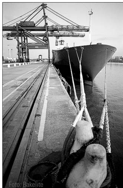
Verwendung von Dyneema® bei Schiffstauen
