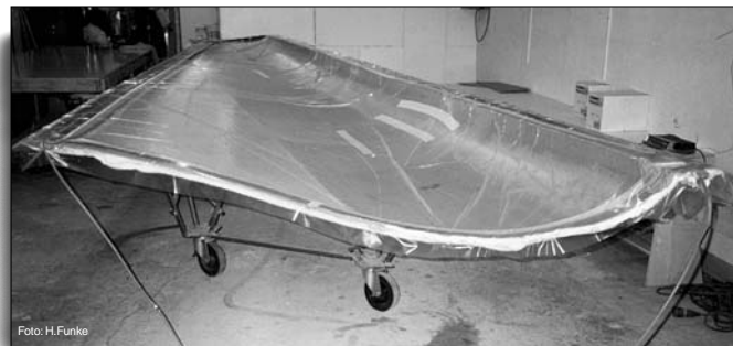
Flügelschale eines UL-Flugzeuges im Vakuum. Skin of a microlight wing in vacuum
