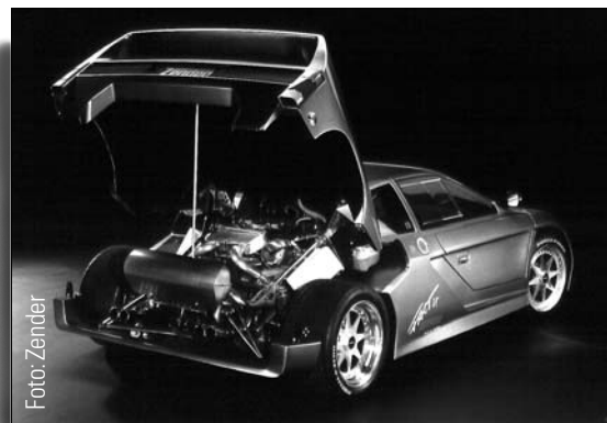
Fünf Kohlefaser-Bauteile bilden die 55 kg leichte Zender Fact-4 Karosserie.
