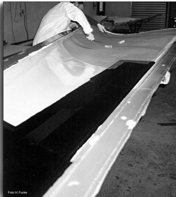
Handlaminieren von Glas-, Aramid- und Kohlenstoff-Filamentgeweben im Flugzeugbau
