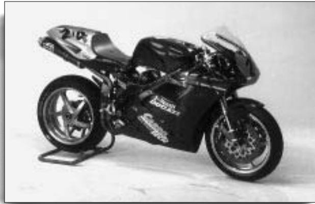
Motorrad mit einem Rahmen aus Faserverbundwerkstoffen aus der Fertigung der Firma CarboTech Composites GmbH, A-Salzburg
