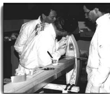
Handlaminat Verkleben von Tragflächenrippen auf einen Holm aus GFK (Flugzeugbau-Workshop der Aero-Luftfahrtmesse, Friedrichshafen)
