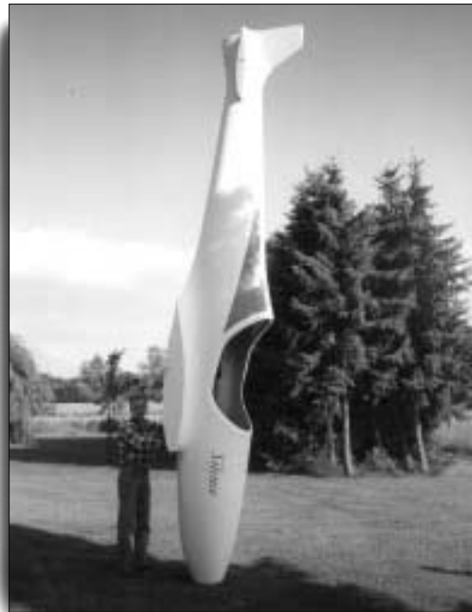
Flugzeugrumpf in Waben-Sandwichbauweise
