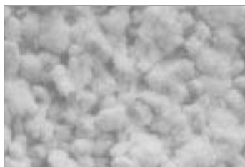
Glasfaser gemahlen Milled glass fibre
