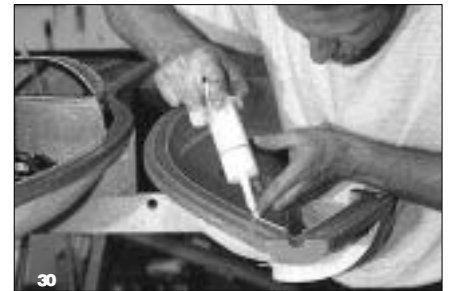
Zum Verkleben der Rumpfhälften wird eine Raupe aus einem Harz/Glas-Bubbles-Gemisch beidseitig auf die Klebestellen aufgetragen.
