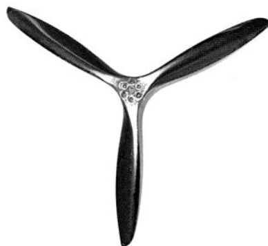
Dreiblatt Luftschaube, mit Kohlerovings verstärkt Three-bladed propeller reinforced with carbon rovings
