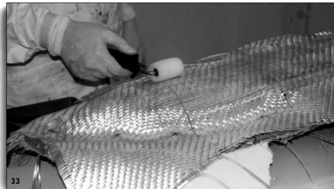
Überschüssiges Harz der ersten Gewebelagen wird von den weiteren Gewebelagen aufgesaugt ( Bild 33 ).
