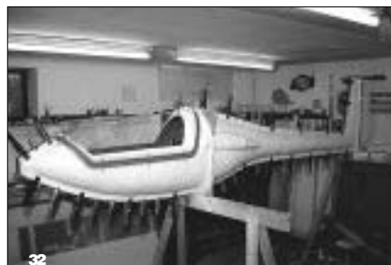
Klammern pressen die geschlossene Form zusammen.
