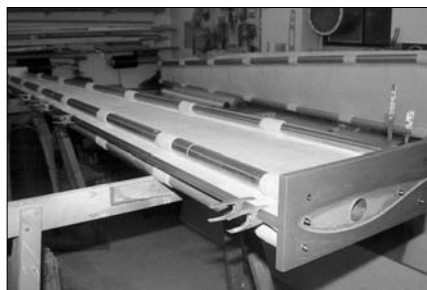
Versteifung der Formhälften mit je zwei 50 mm Alu-Rohren
