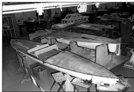
Die fertige Bootsschale wird mit dem Deck verklebt
