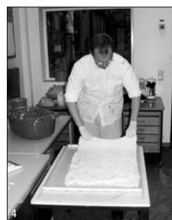
4 ...wird das M 1-Gewebe auf das "nasse" Epoxydharzlaminat gelegt...
