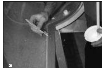
Die Kante im Bereich des Kabinenhauben-Ausschnitts wird mit einem Harz-Baumwollflocken-Gemisch geschlossen.
