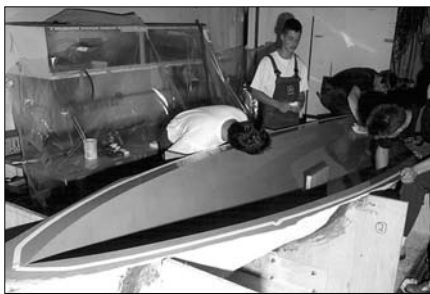
Negativ-Form aus Epoxydharz/Laminierkeramik
