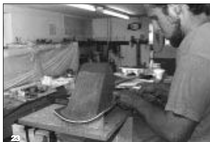
Unter Einblasen von Luft wird diese dünne Schale entformt, der Positivkern erneut gewachst und die GFK-Schale wieder aufgeschoben (reine Vorsichtsmaßnahme bei schwierig zu entformenden Teilen).
