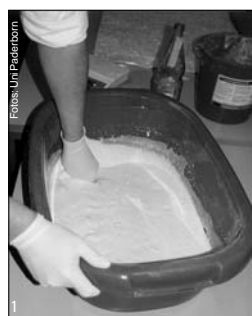
1 Anmischen der Laminierkeramik (0,28 Liter Wasser auf 1 kg Pulver)
