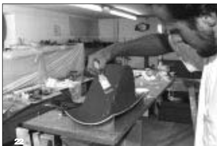
Laminieren des Fahrwerksschachts über ein aus Holz erstelltes Positiv. Zwei Lagen 80 g-Gewebe reichen aus.
