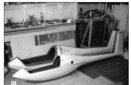
Nach 24h Härtung wird der Rumpf entformt. Das Gesamtgewicht beträgt 8,5 kg davon abziehen sind 4,5 kg für das Klapptriebwerk und 1,5 kg für Einziehfahrwerk und Spant. Es bleibt ein Schalen-gewicht von 2,5 kg für einen Rumpf mit ca. 2,5 m 2 Fläche.
