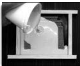
Vor dem Abformen wird Trennspray aufgetragen und dann der PU-Kautschuk vergossen
