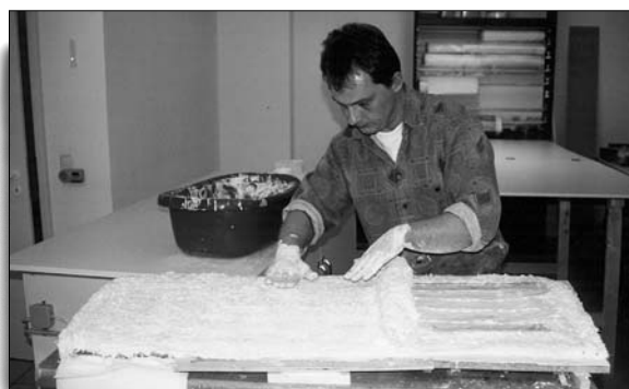
Eine weitere Lage M1-Gewebe/Laminierkeramik deckt das stromführende Kohleband ab.
