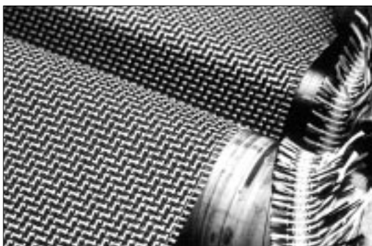
Noch an der Webmaschine wird ein Teil der Webkante abgeschnitten.
