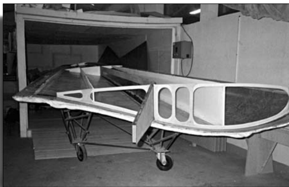
Holm und Flächenschale eines UL-Nurflüglers
