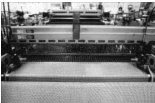
Durch Verkreuzung der Kettfäden mit dem Schußfaden entsteht das Gewebe.
