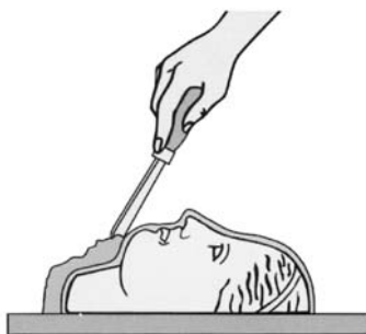
Hautformen im Streichverfahren (ELASTOSIL® M 4503 + Verdickungsadditiv M bzw. M 4601/4641 + Stabilisator 43)
