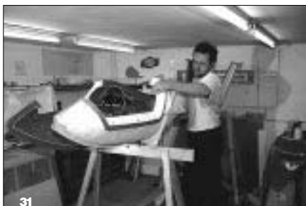
Die beiden Formhälften werden aufgestellt und vorsichtig zusammengeschoben.
