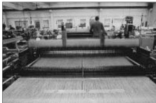
Zuführung einer Aramid-Kette in die Webmaschine.
