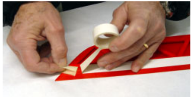
Links und rechts Klebeband nochmals lösen und Abdeckband-Fixierung entfernen, dann erneut andrücken.
