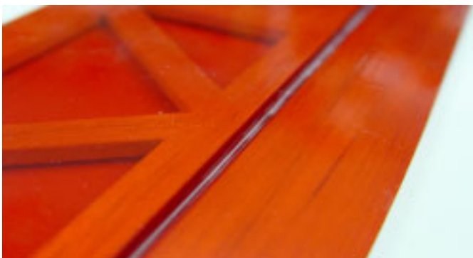
Hier das fertige Silikon-Ruderscharnier an einem gewöhnlichen, Oracover-Light bespannten, Rippen-Höhenruder.
