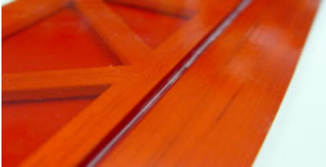
Ruder und Fläche mit Abdeckband fixieren. Abwechselnd links und rechts korrigieren bis 1-2mm Spalt vorhanden.
