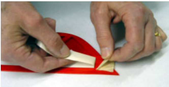
Links und rechts Klebeband nochmals lösen und Abdeckband-Fixierung entfernen, dann erneut andrücken.
