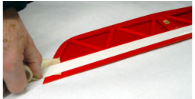
Mit stabilem (nicht zu weichem) Klebeband, (ev. 2-3 Lagen) Spalt überdecken und sehr gut andrücken.
