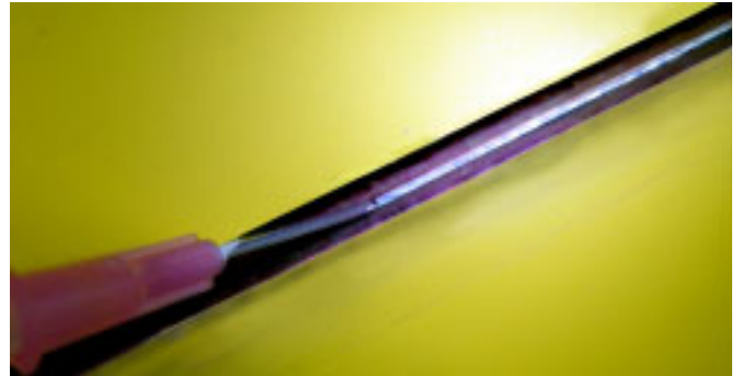
zum ca. 1mm dicken Auffüllen des Ruderspalt.
