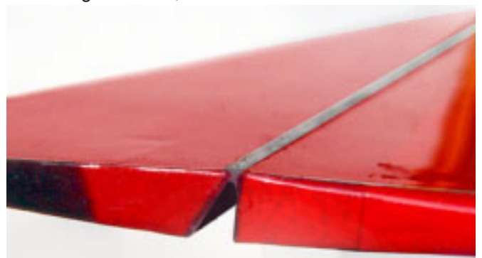
Hier das fertige Silikon-Ruderscharnier an einem gewöhnlichen, Oracover-Light bespannten, Rippen-Höhenruder.
