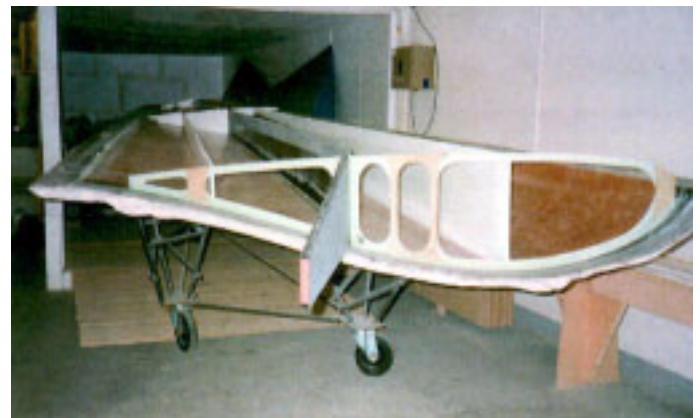
Holm und Flächenschale eines UL-Nurflüglers
