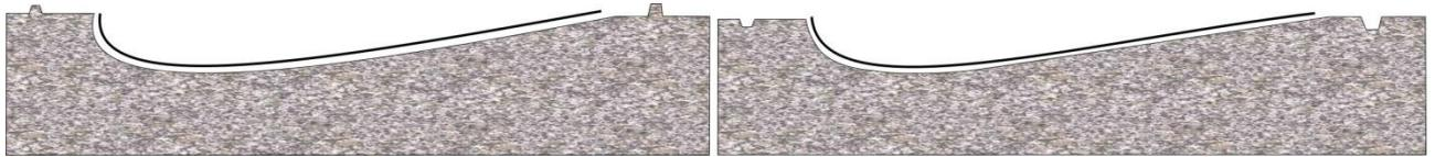
Stratification au contact des peaux dans le moule ou compactage sous vide du pre-peg.
